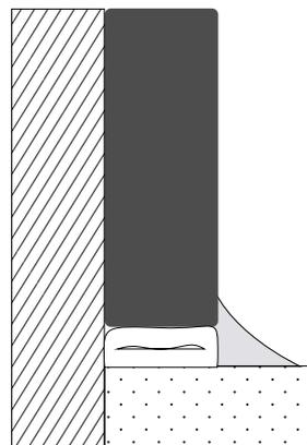
**3** Finition avec un joint de silicone
